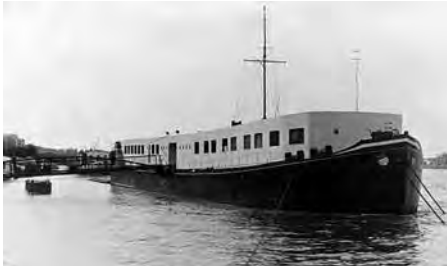
Aus alt mach neu: In der Nachkriegszeit wurde das Bootshaus aus zwei Schiffen zusammengeschweißt.
